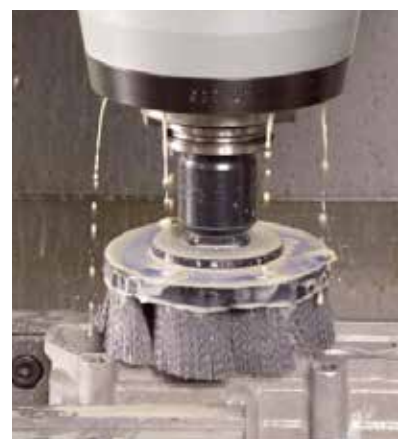
ウェット加工時のクーラント供給例
