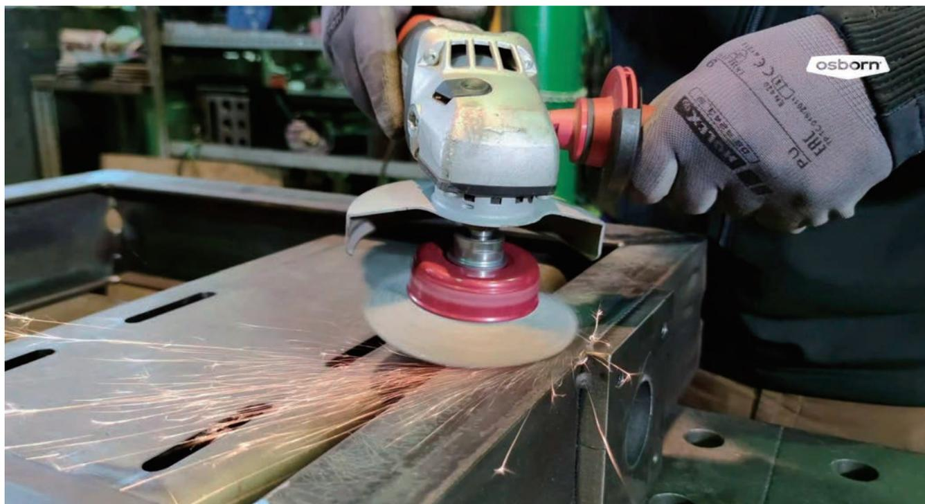
エクストリームワイヤは4本の細いワイヤーをねじり合わせたワイヤーでノット(ひねり)ブラシの研削力と柔らかいクリンプワイヤブラシの柔軟性を兼ね備えたブラシです。特に塗装前の表面処理に最適です。
