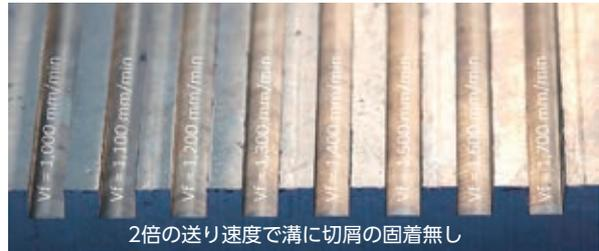
2倍の送り速度で溝に切屑の固着無し
