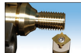
0.5~3mmピッチのネジ切り加工
