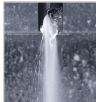
● 高圧クーラントをインサートの先端に直接かけることが可能。
