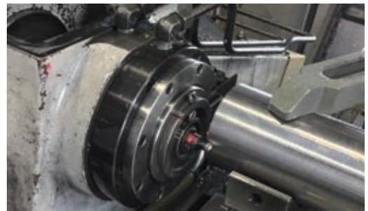
ガンドリルマシン用タッチファインダφ18(001821800)とφ25.0(001822500)はLEDから先端ボール部までを短く設計しています。その為オーバーラン保護機能用のばねが非常に短い為、オーバーランしすぎるとばねが伸びボールの座りが悪くなる可能性があります。オーバーランした時は必ずボールの座りをご確認下さい。誤ってボールの座の部分にワークに接触させた時、高価な機械部品の損傷を防ぐ為、LEDライト部の樹脂部分から破損する構造を採用しております。
