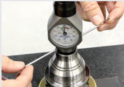
② 4箇所 screws により、振れがゼロになるように調整してください。
