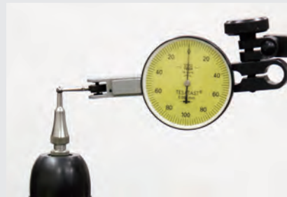
③ 振れ調整後はスタイラスに触れないでください。
