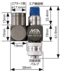
エアスイベルジョイントはグラインダ等のエア機器本体とエアホースの間に装着する事で、エア機器使用中エアスイベルジョイントが空気圧で回転しスムーズに作業が行えます。エアが供給されていないとエアスイベルジョイントは回転しません。
