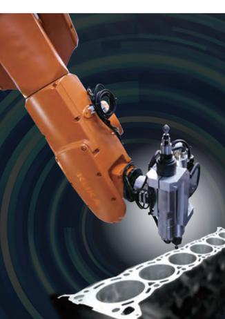
**バリ取りロボット等で使用する超硬バーは刃径公差±0.025mmのMRA超硬バー「MPシリーズ」を推奨いたします。**
